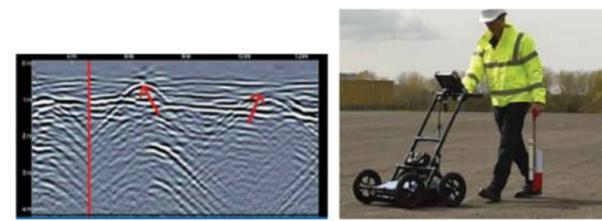
■ 透過式漏水・漏洩探知法
