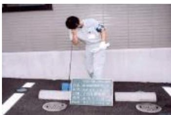
メータ、公道の栓・弁を接点として漏水の有無を調べる
