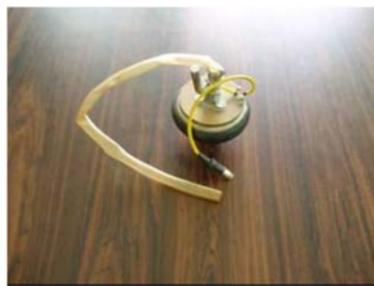
国内での水中漏水伝搬音探知, 水中センサ
