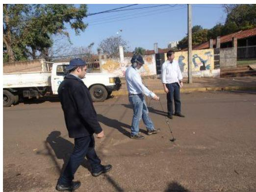
漏水探知器による探知(絞り込み)
