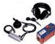
今回、音聴調査として仕様とされている方法は、大口径の頂部に感震棒を穿孔挿入させ、管体に伝搬している漏水音(疑似漏水音)を捕捉して効果的な音聴方式を勘案するものである。
