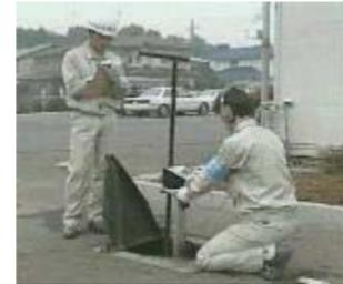
水中相関と原理は似ていますが、水中マイクロフォンを使用して調査します。この機器を利用して水中を伝搬する漏水音を捕捉する。漏水らしき音がある路線を選定対象管路として調査します。
