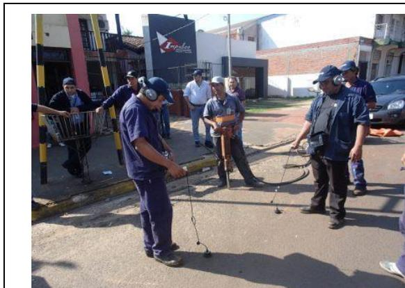
漏水探知器による探知(絞り込み)
