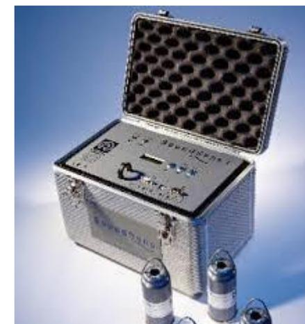
A点にて漏水疑似音を発生させ、B側に向かい穿孔し、2mピッチに鋼感振棒を挿入し26mまでの13測点にて探知を行った。疑似漏水量は2Ltr/min、4Ltr/minで試験している。
